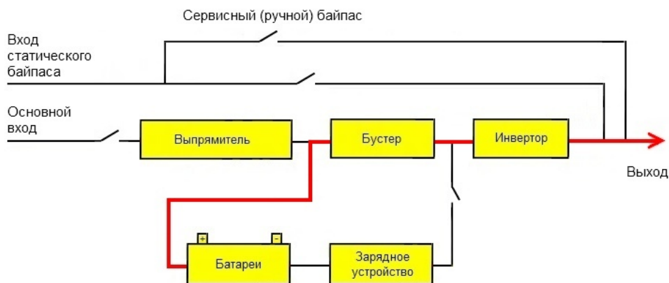
Схема работы в режиме от батарей.
