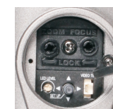
Регулировка зума и фокуса объектива
