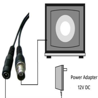
Рис.2.4. Коммутация разъемов видеокамеры
