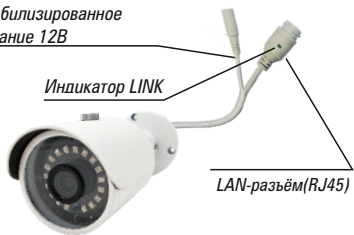
Рис. 1 Схема подключения видеокмеры
